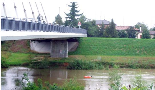
Nel corso dello spostamento la sonda rileva ad intervalli di tempo regolari, il profilo della velocità della corrente lungo la verticale, dalla superficie al fondo.
